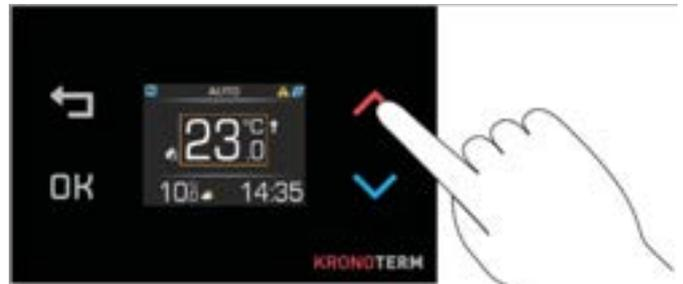
Drücken Sie die Taste oder für die Anzeige der eingestellten Raumtemperatur. Die Temperatur wird durch einen orangefarbenen Rand gekennzeichnet.
