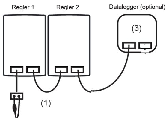
Die Regler werden mit dem CAN-Bus Kabel (1) in Reihe verbunden.
