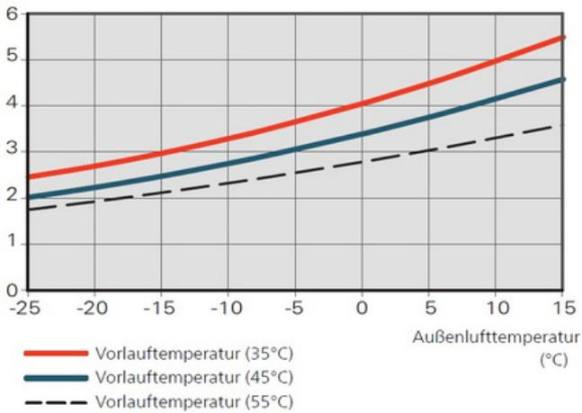
F2120-16 max. und min. Kühlleistung in kW
