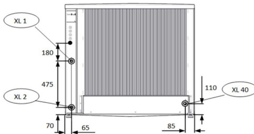
XL1 : Anschluss Heizungs-Vorlauf G 1 1/4" AG (Austritt Wärmepumpe) XL2
