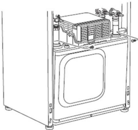
Elektrische Verbindung lösen
