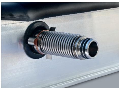
Für eine sichere Verbindung der Kollektoren untereinander werden speziell entwickelte Kompensatoren verwendet. Das Hydraulikkonzept mit durchgängigen Sammelleitungen erlaubt eine einfache Leitungsführung und ermöglicht die Installation von beliebig großen Kollektorfeldern. Dank werkzeugloser Montage kann die Installation der Kollektorverbindungen einfach, sicher und zeitsparend realisiert werden.
