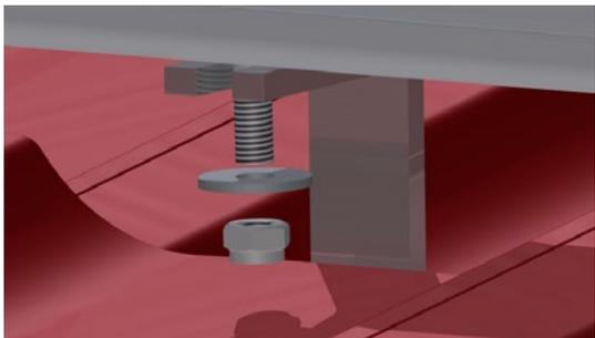
Montieren Sie Profilschienen auf den Dachhaken. Führen Sie dazu die Vierkantschraube durch das Langloch im Dachhaken und fixieren Sie diese mit der U-Scheibe und Mutter.
