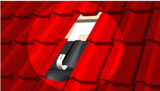
Den oberen Montagelappen montieren. Seitlich ebenfalls aufbiegen. Die Schrauben des Ziegelhakens müssen überdeckt sein. Den Montagelappen gegen Abrutschen sichern, z.B. durch Anfalzen an der oberen Latte.
