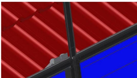
Das Zwischenblech wird oben in die Kollektornuten eingeführt.
