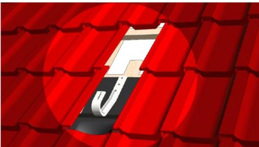
Der Ziegelhaken darf den unteren Ziegel nicht überdecken. Anderenfalls kann ein Druckpunkt auf dem unteren Ziegel entstehen.
