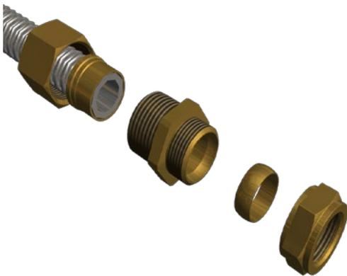
Im nächsten Schritt werden die Komponenten gemäß nebenstehender Zeichnung auf das Rohrende geschoben. Achten Sie dabei darauf, dass das Rohr durch den Stauchring bis zum Anschlag in den Fitting geschoben wird. Ziehen Sie nun die Überwürfmutter handfest an. Anschließend wird die Mutter mit 3 1/2 bis 4 Umdrehungen mit entsprechenden Schlüsseln festgezogen.
