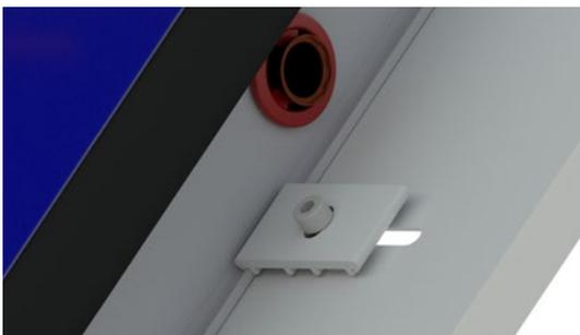
Montieren Sie anschließend auf der nächsten Konsole die Befestigungsplatte „doppelt“ im oberen und unteren Langloch vor. Die endgültige Fixierung erfolgt nach der Montage des nächsten Kollektors.
