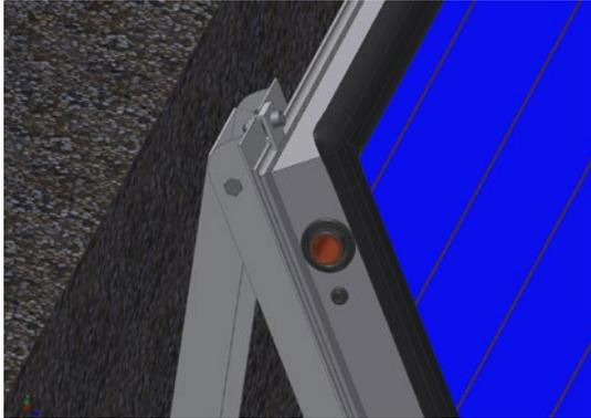
Werden die Konsolen bündig mit den äußeren Kollektoren montiert, werden diese abschließend mit den beigeestellten Befestigungsplatten gesichert. Montieren Sie dazu die Befestigungsplatten am oberen und unteren Ende der Konsole in den vorgesehenen Löchern.
