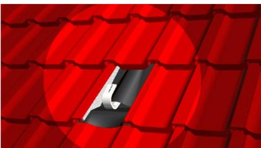
Alle weiteren Ziegelhaken in einer Reihe müssen exakt ausgerichtet werden (z. B. mit Schnurschlag).
