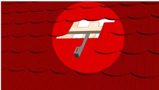
Den Ziegel schroten und anschließend eindecken.
