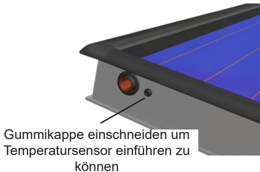
Konstruktiv ist die Einschubtiefe des Sensors auf 4 cm begrenzt. Eine zusätzliche Sicherung gegen Herausrutschen wird empfohlen. Bedingt durch den Messpunkt am Absorber kann der Temperaturfühler an einem beliebigen Kollektor des Feldes installiert werden.
