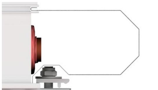
Alle SnapCover Bleche werden auf die selbe Weise montiert. Zunächst wird das Blech unten in den Kollektorrahmen eingehängt, bevor es mit der Falz oben in die Aussparung im Kollektorrahmen gedrückt wird.
