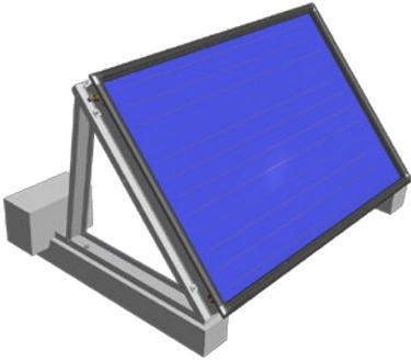
Zur Kollektormontage legen Sie zunächst den äußeren rechten oder äußeren linken Kollektor auf die montierten und fixierten Konsolen auf. Achten Sie bei der Montage des Kollektors darauf, dass die äußere Konsole zu ca. 50 % durch den Kollektor überdeckt werden muss.
