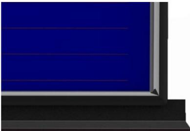
Die Montage der rechten Ecke erfolgt analog zur Montage der linken Ecke. Es wird zunächst das Traufblech montiert.
