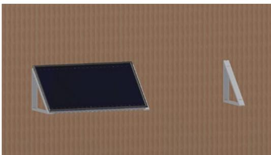
Setzen Sie anschließend den ersten Kollektor auf die vormontierten Konsolen auf.
