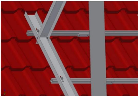
Bevor die Befestigungsprofile endgültig auf den Dachhaken fixiert werden, muss vorab die exakte Lage geprüft werden (Wasserwaage, Schnurschlag).
