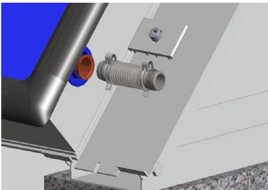
Bevor der folgende Kollektor montiert werden kann, muss der hydraulische Kollektorverbinder am bündig hervorstehenden Kollektoranschluss montiert werden.
