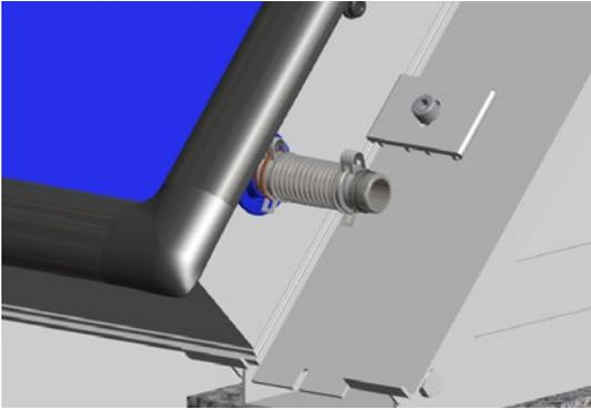
Führen Sie den hydraulischen Kollektorverbinder in das Sammelrohr ein. Achten Sie dabei darauf, dass beide O-Ringe montiert sind. Schieben Sie den Verbinder bis zum Anschlag und fixieren Sie diesen mit der Sicherungsfeder.
