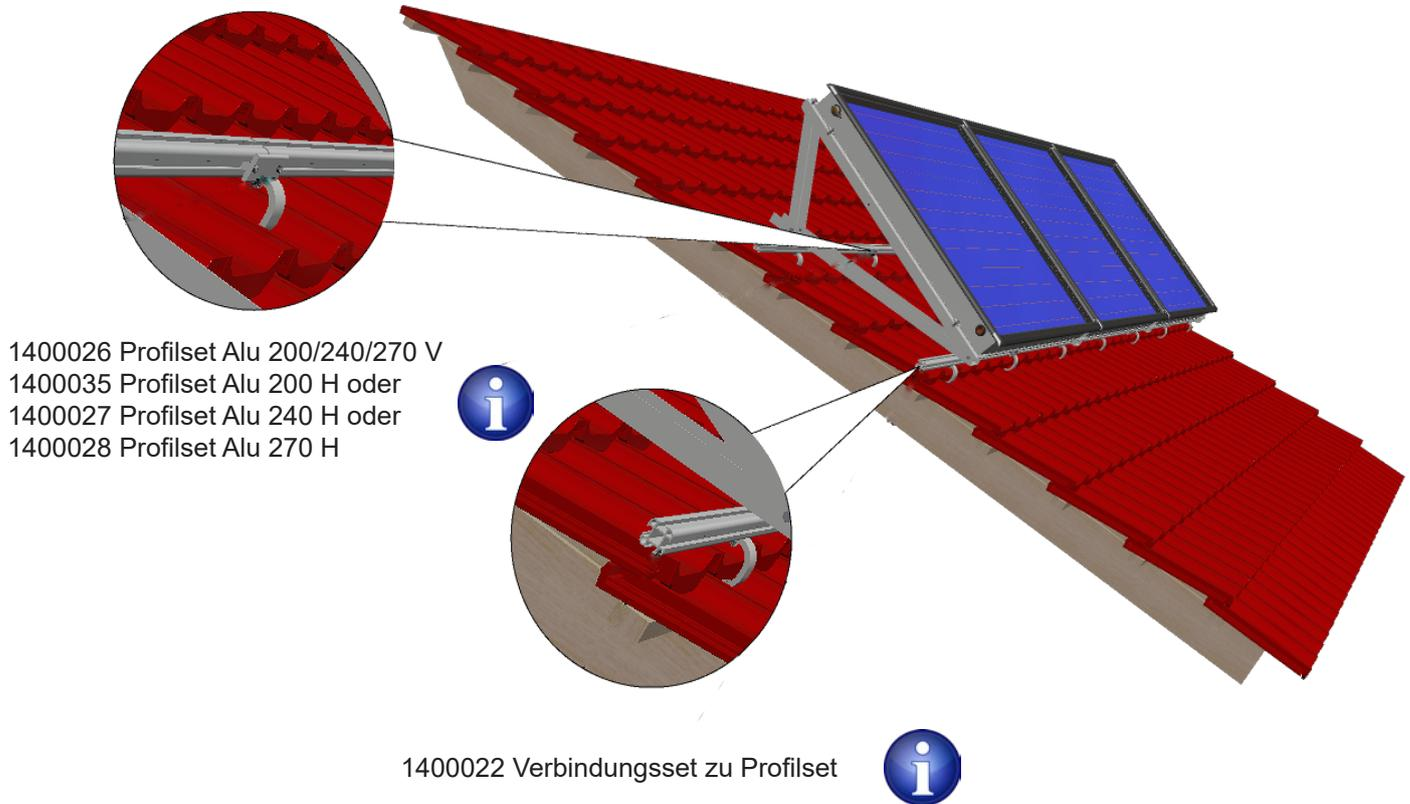
Bei Aufdachanlagen werden Profilsets in Abhängigkeit zum Kollektortyp geliefert. Werden mehrere Kollektoren in einer Reihe verbaut, wird für jeden Kollektorübergang ein Verbindungsset erforderlich.
