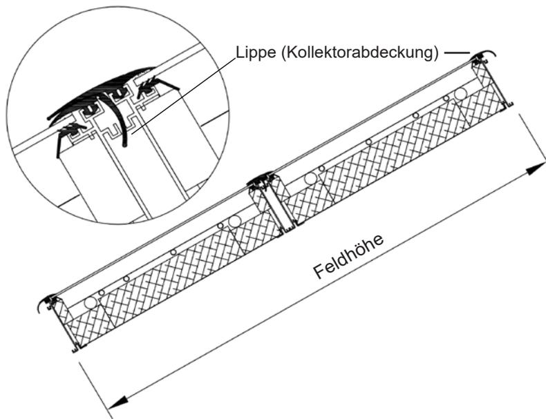
Bei mehrreihigen Anlagen werden die Kollektoren in den Reihen übereinander immer auf Stoß montiert. Dabei wird die Lippe (Kollektorabdeckung) des oberen Kollektors über den unteren Kollektor gelegt. Die Lippe (Kollektorabdeckung) des unteren Kollektors wird im Stoßbereich verklemt, so dass ein optimaler Wasserlauf gewährleistet ist.
