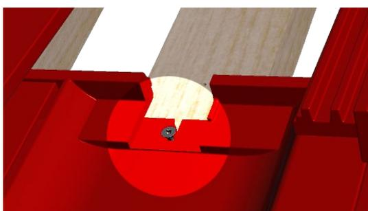
Fertig montierte Schraube als Abstandshalter.
