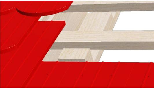
Montage der unteren Ziegelhakenauflage 80x50x45 mm mit zwei Schrauben 5x60 mm.
