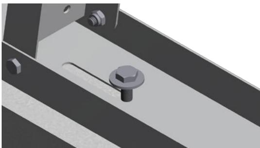
Platzieren Sie anschließend die Bodenkonsolen auf den Betonsockeln und befestigen Sie diese mit den beigegefügt Schrauben M10. Alle weiteren Konsolen müssen exakt in einer Reihe ausgerichtet sein (z. B. Schnurschlag)
