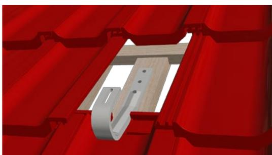
Befestigen Sie nun den Ziegelhaken mit der Unterlage 50x150x5 mm und zwei Schrauben 5x60 mm.
