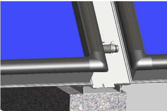
Den nächsten Kollektor an den bereits vorhandenen Kollektor heranschieben. Dabei ist zu beachten, dass die Dehnungskompensatoren ordnungsgemäß bis zum Anschlag in das Kollektorsammelrohr eingeführt werden.
