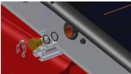
Der Verschlussdeckel wird bei allen nicht verwendeten Kollektoranschlüssen montiert.
