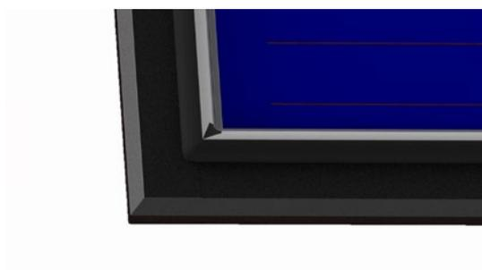
Das Traufblech und das Seitenblech jeweils so weit verschieben, dass eine geschlossene Ecke entsteht.
