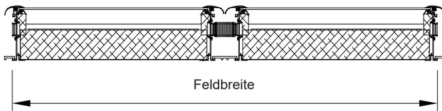
In einer Reihe nebeneinander montierte Kollektoren werden immer mittels Edelstahlkompensatoren über die Sammelrohranschlüsse miteinander verbunden (siehe Bild).
