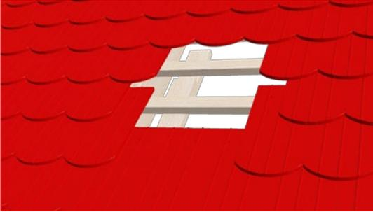
Befestigen der untenliegenden Latte 24x80x600 mm mit zwei Schrauben 4x50 mm.
