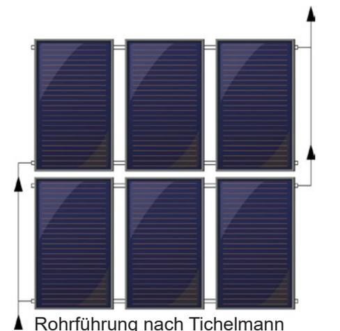
Bei mehrreihigen Anlagen, sowie Anlagen mit STI Drain Back System muss die Verbindungsleitung immer über die Diagonale an die externe Sammelleitung angeschlossen werden (Tichelmann), z.B. links unten und rechts oben.
