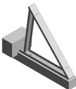
Beschweren Sie nun den Betonsockel optional mit einem weiteren Betonsockel. Bereiten Sie zur Kollektormontage alle Konsolen wie obenstehend beschrieben vor. Alternativ kann bauseits ein Betonelement zur Sicherstellung der Grundlast verwendet werden.
