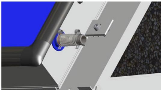
Führen Sie den hydraulischen Kollektorverbinder in das Sammelrohr ein. Achten Sie dabei darauf, dass beide O-Ringe montiert sind. Schieben Sie den Verbinder bis zum Anschlag in das Sammelrohr und fixieren Sie diesen mit der Sicherungsfeder.
