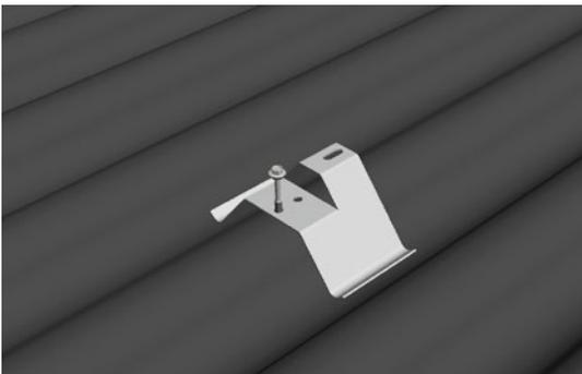
Die Löcher für die Befestigungsschrauben in der Welleindeckung sind mit einem 8 mm Bohrer vorzubohren. Die Befestigung der Dachhaken erfolgt mit den Fassadenschrauben 6,5x100 mm mit Dichtscheibe.
