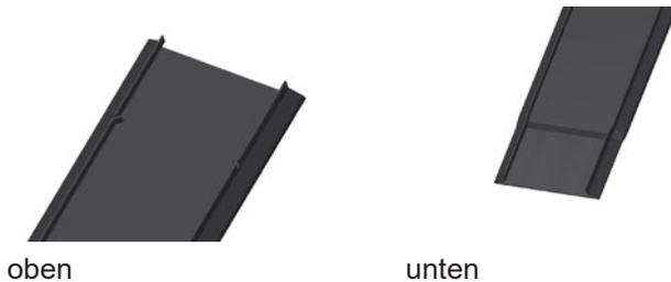
Es wird empfohlen, die Zwischenbleche nicht bei erhöhter Sonnenstrahlung / Temperatur zu montieren. Die mögliche Wärmeausdehnung des Kollektors kann zu einer erschwerten Montage führen.
