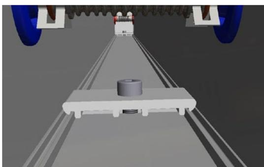
Achten Sie darauf, dass die Befestigungsplatte „doppelt“ beidseitig in das Kollektorprofil einhakt. Fixieren Sie anschließend die Befestigungsplatte.
